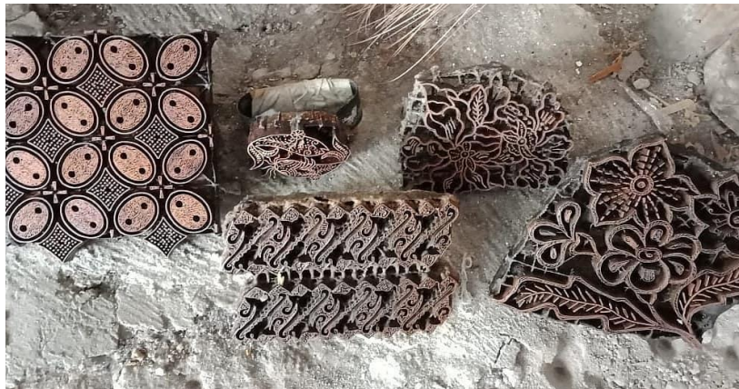
Gambar 2. 9 foto hasil pembuatan mal kuningan batik cap
