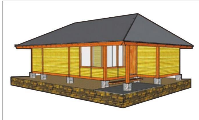
Gambar 2.7 Sketsa Suhunan Perahu Kumureb (Sumber : Rumah Etnik Sunda-Henri Anwar dan Hafiz A. Nugraha)
